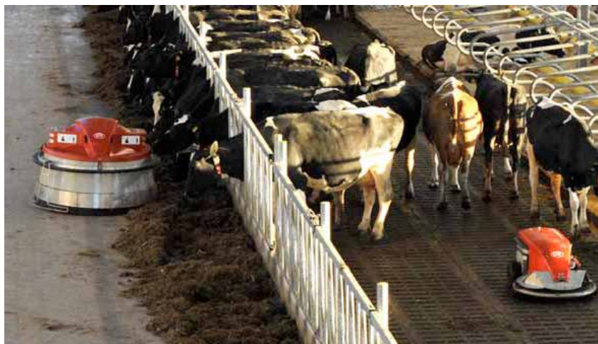
Fot. 2. Zastosowanie robotów do podgarniania dawek pokarmowych na stole paszowym i usuwania odchodów na rusztach
